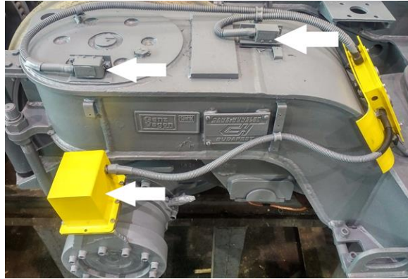
38. ábra. Az FMK-007 mérőkocsi gyorsulásmérőinek forgóvázra és csapágytokra erősített szenzortartói
